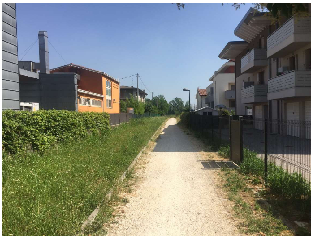
Foto n° 48 - Pista ciclabile, in sinistra fosso tombinato tramite scatolare (1,50x1,00m)
